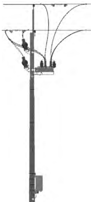
Рис.8.13. Пример установки реклоузеров L5
