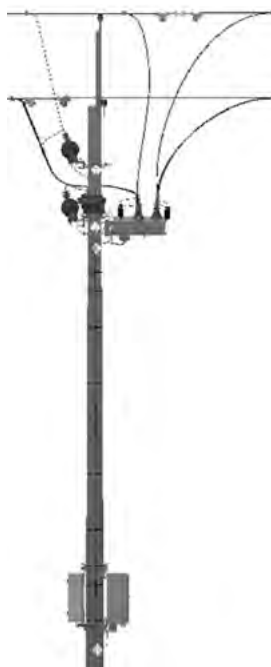
Рис.8.14. Пример установки реклоузера R5
