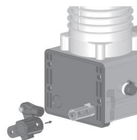
Рис. 22. Установка шарнірного вузла в зборі на імітатор валу
