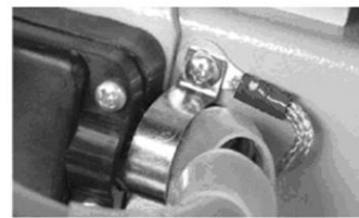
Рис. 14. Приклад виконання заземлення екрану одного джгута
