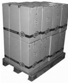
Рис. 32. Групове упакування ВВ (вісім штук при транспортуванні на європалеті)
