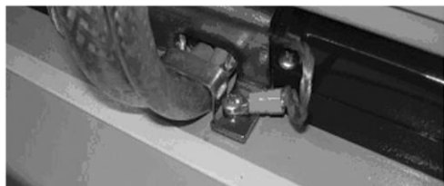
Рис. 13. Приклад виконання заземлення екранів двох джгутів
