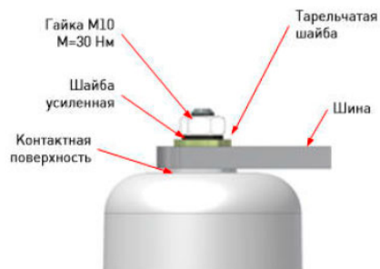
Рис. 14. Встановлення верхніх додаткових терміналів (рекомендується)
