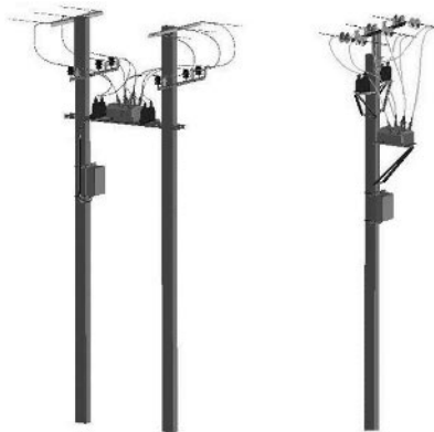
Рис. 4.22. Варианты установки реклоузера на опоры ВЛ
