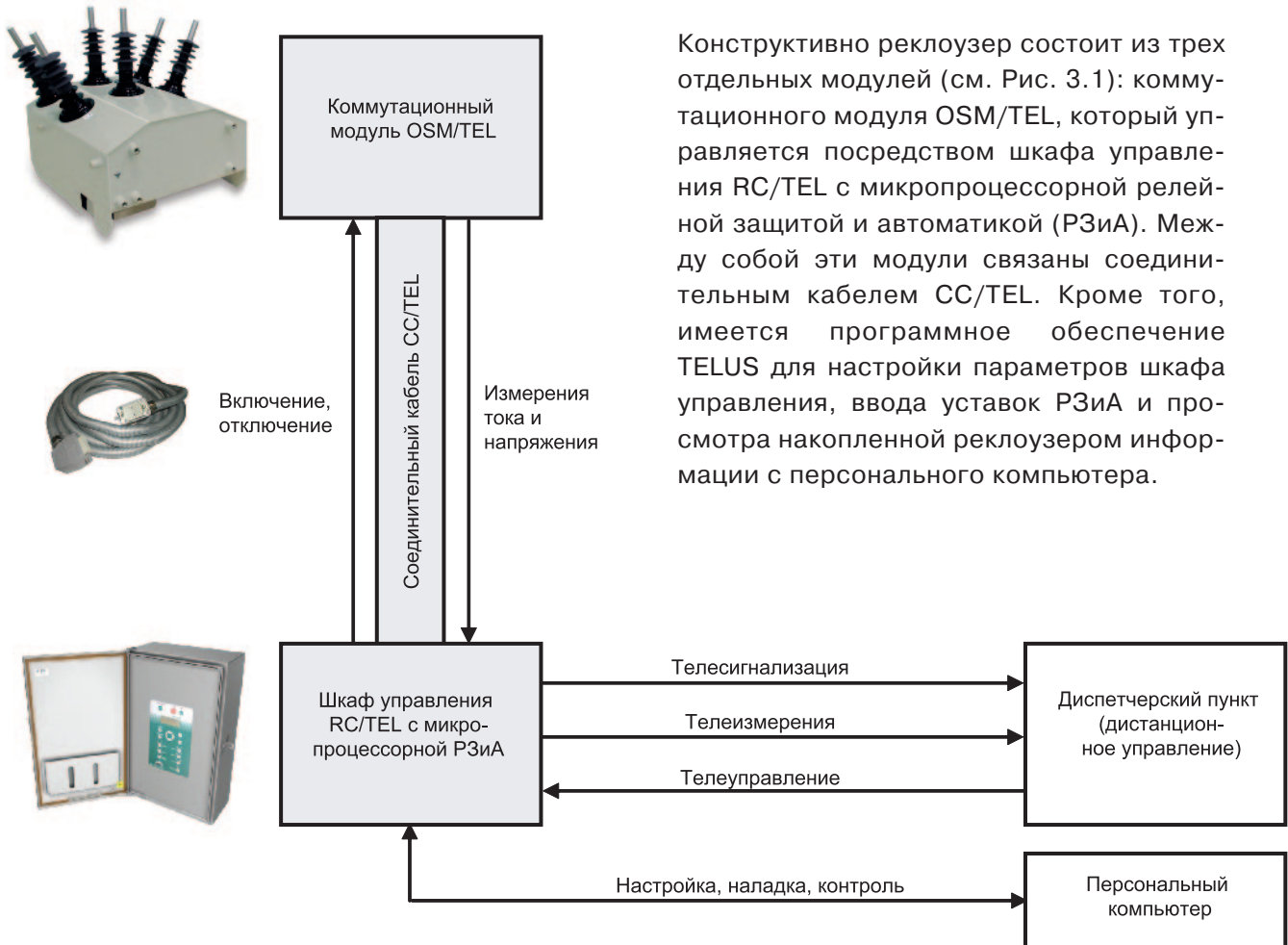
Рис. 3.1. Принципиальная электрическая схема включения РВА/TEL
