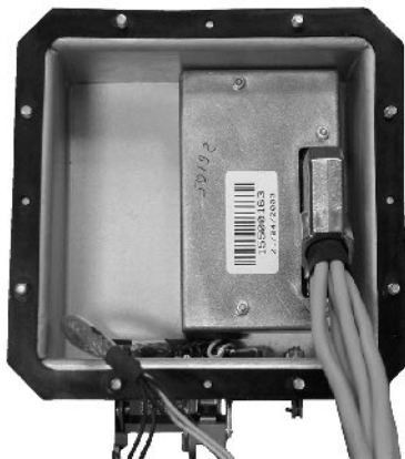
Рис. 3.11. Защитная крышка разъема вторичных цепей и штепсельный разъем
