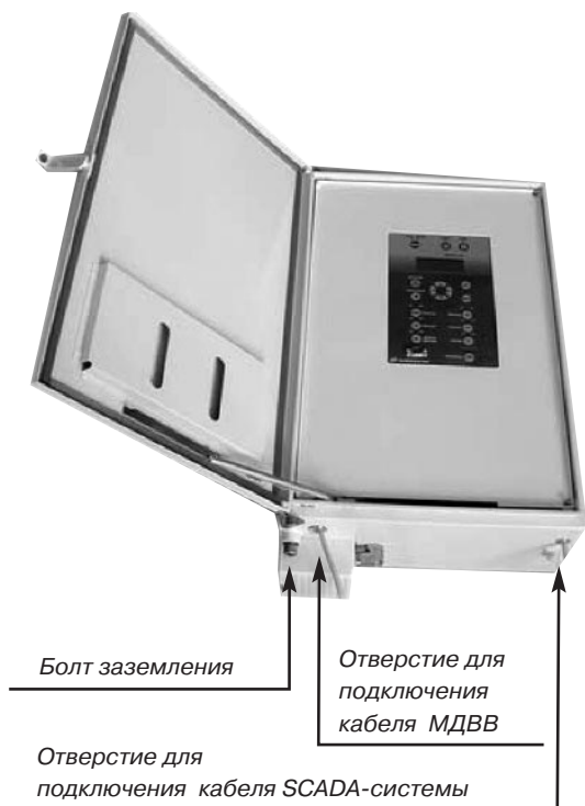
Рис. 4.7. Подключение коммуникационных кабелей
