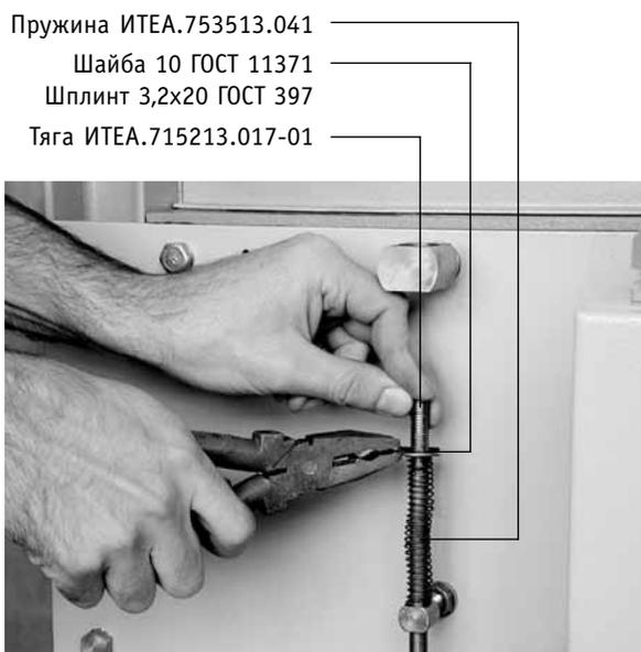
Рис. 14.11 Установка толкателя ИТЕА.716334.007 на ВЭ МВ АК 10/1250/20 и АК 10/2000/20
