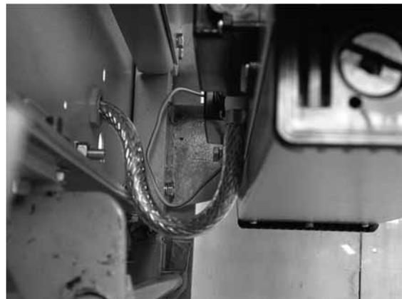
Рис. 10.5 Организация прохода жгута через фасадную панель ВЭ МВ АК 10/2000/20
