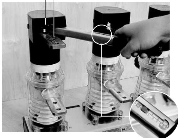
Рис. 7.2 Установка кронштейнов крепления ВВ и изоляционных барьеров
