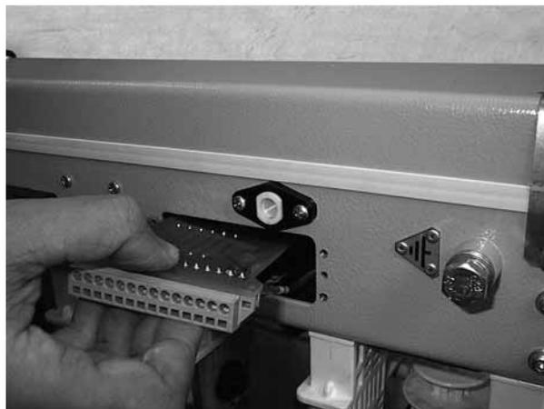
Рис.18.3 Подключение выводов катушки привода ВВ к клеммным выводам платы
