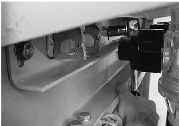
Рис. 10.2 Крепление фасадной панели ВЭ
