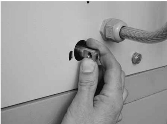
Рис. 14.3 Установка кронштейна узла индикации и аварийного отключения
