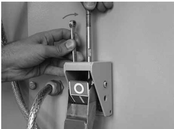
Рис. 14.6 Установка корпуса узла индикации и аварийного отключения
